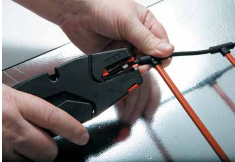
Рис. 7. Снятие изоляции с мест разреза UNIMAT
